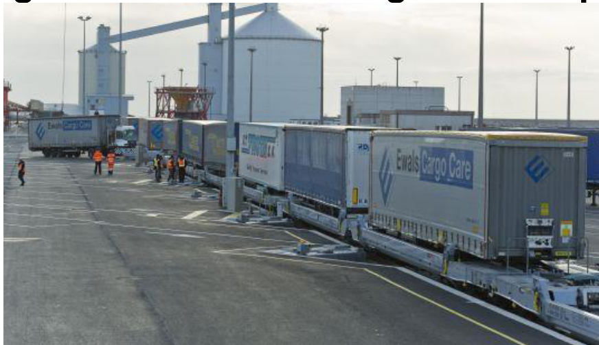
Le ferroutage permet le transport de semi-remorques, sans tracteur ni chauffeur.
